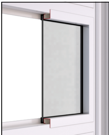
PARECLOSAGE PAR CADRE ET JOINT EPDM
